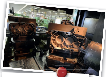
Laufende Serienfertigung auf modernen CNC-Bearbeitungszentren.
